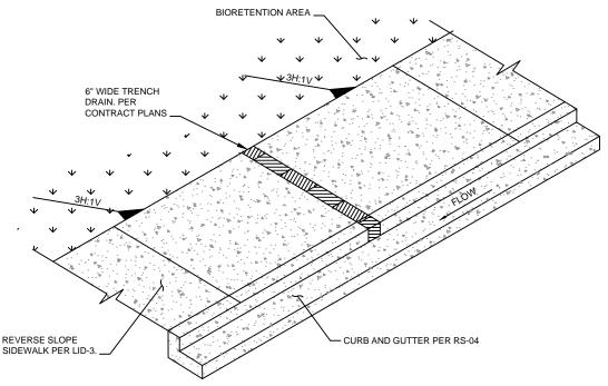
**DETAIL A - BIORETENTION TRENCH DRAIN DETAIL**
